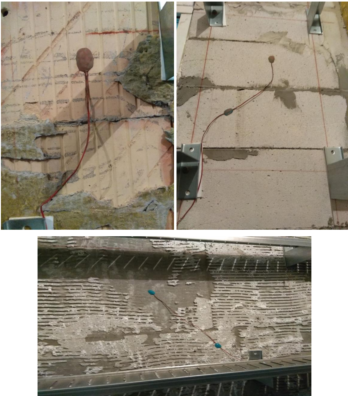
Рисунок 1.9 – Встановлення термодатчиків на зовнішніх поверхнях стінок
