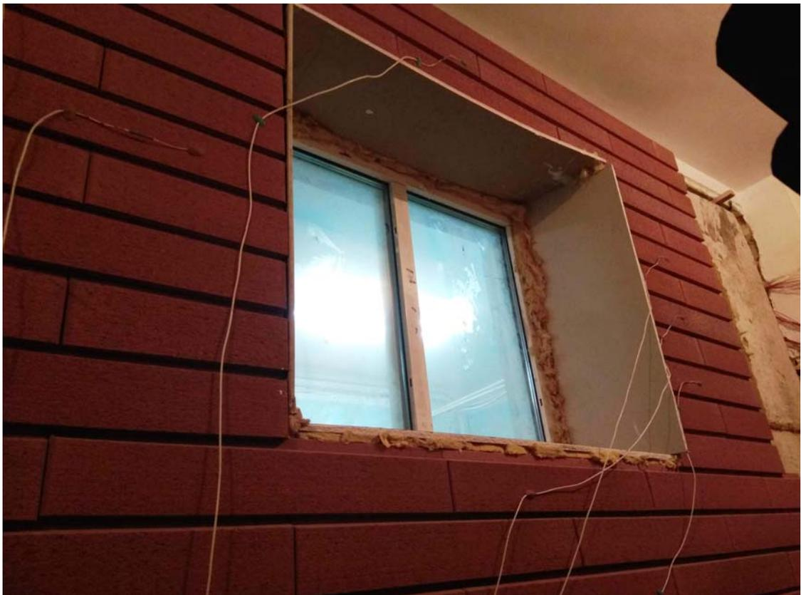
**Рисунок 6** – Загальний вид дослідної конструкції, на основі кладки з газобетонних блоків,
